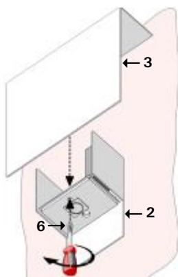
Posizionare il riflettore (3) sul corpo lampada (2) e fissarlo avvitando la vite (6).
