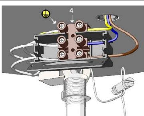
Aggiungere la lampada al soffitto, aprire il morsetto (4) e effettuare i collegamenti rispettando le posizioni dei cavi come indicato in figura e sul morsetto stesso. Chiudere il morsetto e portare il rosone in battuta al soffitto.
