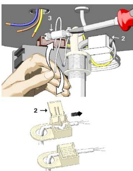
Avvicinare la lampada al soffitto e determinare l'altezza desiderata, posizionando i bloccacavi (2) e (3) in funzione della lunghezza scelta. Per aprire il bloccacavo (2) aiutarsi se necessario con la punta di un cacciavite. Una volta regolata la posizione del cavo di alimentazione, richiudere.
