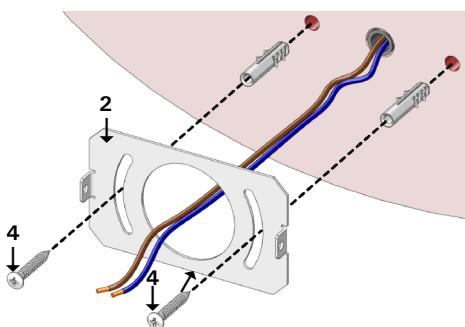
Far passare i cavi provenienti dal muro attraverso il foro centrale della piastra (2). Orientare la piastra (2) e fissarla alla parete tramite le viti (4).
